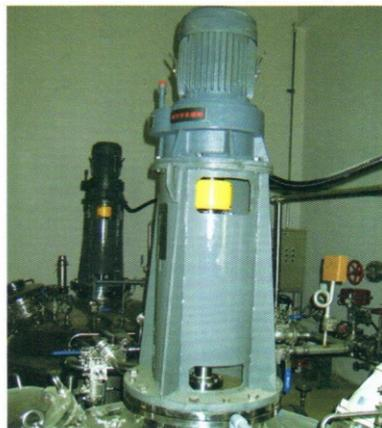
生化發酵槽（卡夾式機械軸封）
